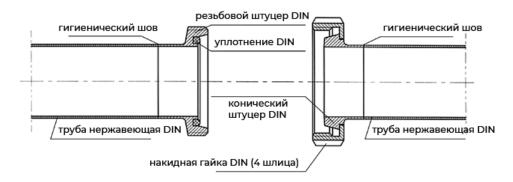
SMS (Swedish Manufacturing Standard / Шведский производственный стандарт). Используется в пищевой промышленности, это соединение с круговой резьбой Rd. Стандартным уплотнением является уплотнение прямоугольного сечения.
